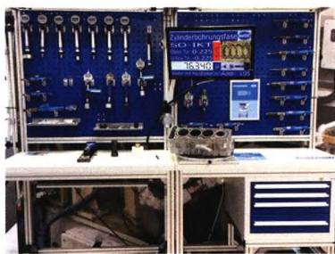
图5 无线传输数据的手持式检具为主体的工序间检测台
