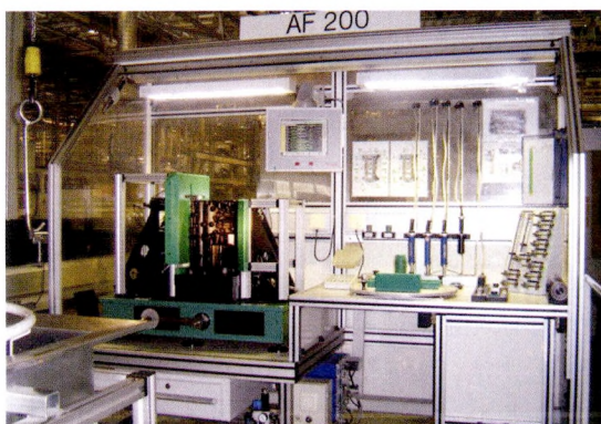
图1 位于生产线旁的带有一系列专用量规的数字化在线检测工作台
