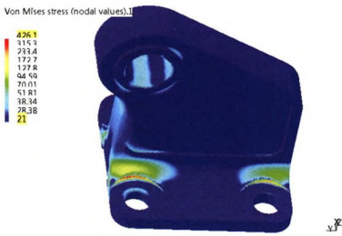
图7 失效沉孔根部应力最大时推力杆支架应力分布图
