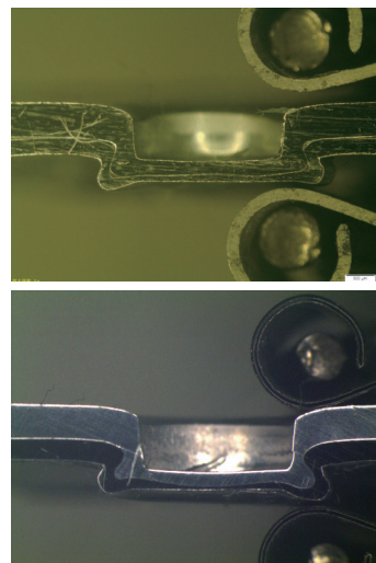
图3 钢件和铝件的剖面图
