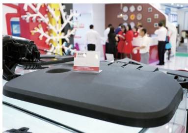
图4 玻纤PP制成的发动机罩
