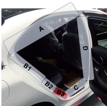
图3 门洞胶条调整区域示意图
