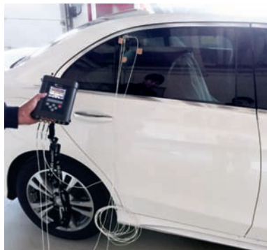
图2 开门抖动加速度传感器测量
