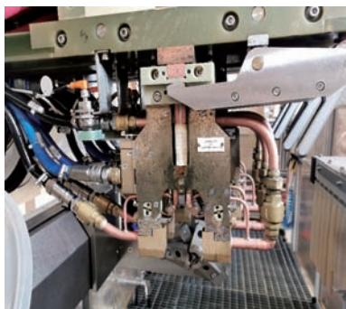
图5 带RFID芯片的淬火感应器
