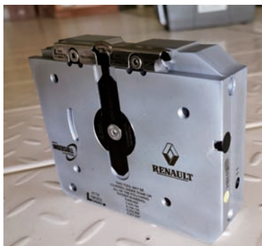
图4 带RFID芯片的滚压头
