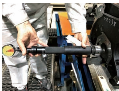
图2 三爪内径塞规在线检测缸体曲轴孔油槽直径
