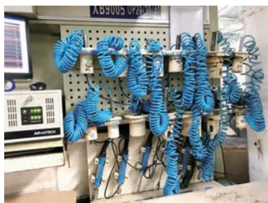
(b) 电子塞规在发动机零部件制造现场的应用
