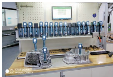
(b) 无线手持式电子塞规在零部件制造中的应用
