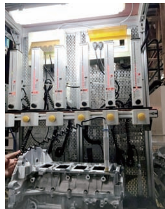
(b) 检测缸体总成孔径
