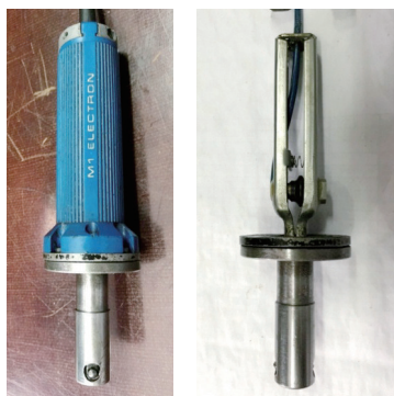
(a) 电子塞规及铰链机械结构
