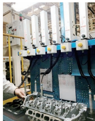
(a) 检测缸盖凸轮轴孔径
