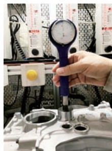
(b) 带表塞规在缸体制造现场的应用
