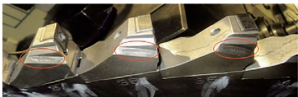
图5 刀夹侧面有干涉痕迹
