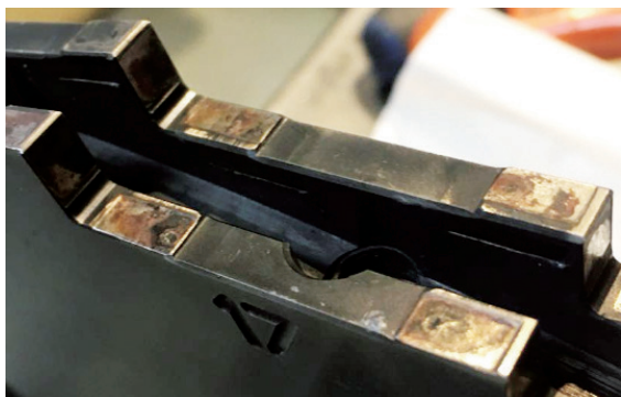
图2 刀夹贴合面变形
