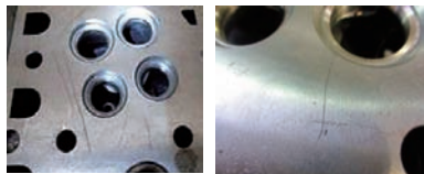
图3 压装平台磨损严重导致缸盖表面产生划痕
