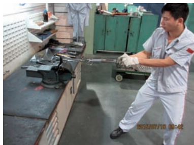
图10 用测量仪测量弹簧力
