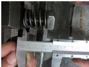
图11 测量弹簧压缩量
