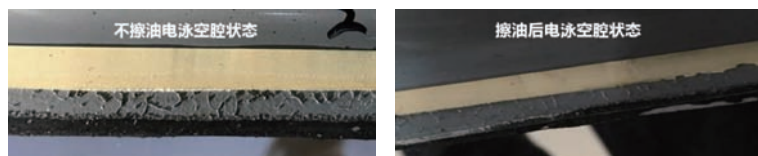
图8 擦油与不擦油的电泳空腔状态
