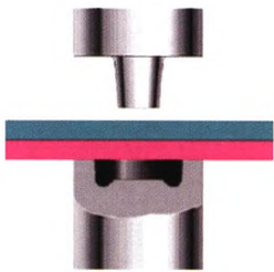
图8 无铆钉铆接工作原理示意
