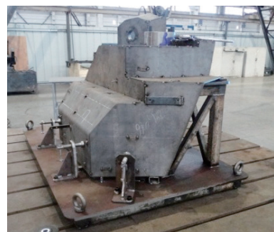
图4 轮舱装焊工装上对轮舱的装夹固定
