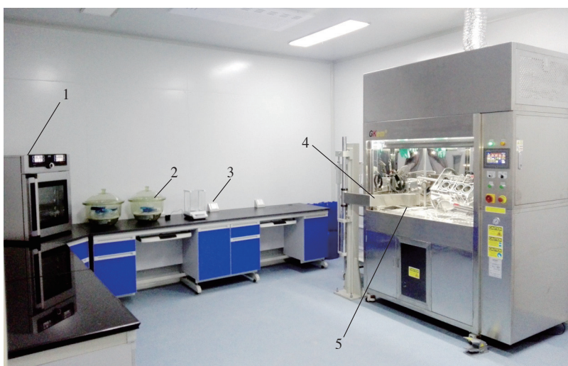
图2 发动机厂清洁度试验室中主要测试设备及其布置参考
