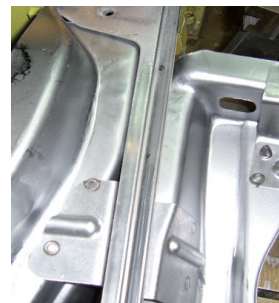
图6 前后导轨焊接Y向
