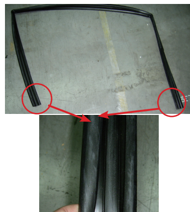
图5 门呢槽内侧X向与玻璃磨损
