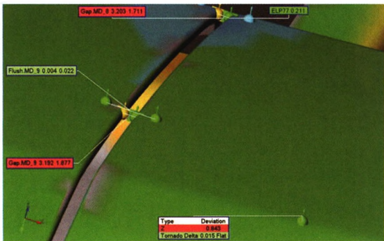
图5 前后门缝隙分析
