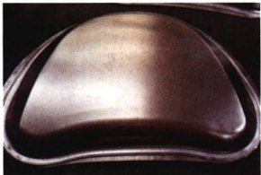
图12 发动机盖板液压成型物理验证件
