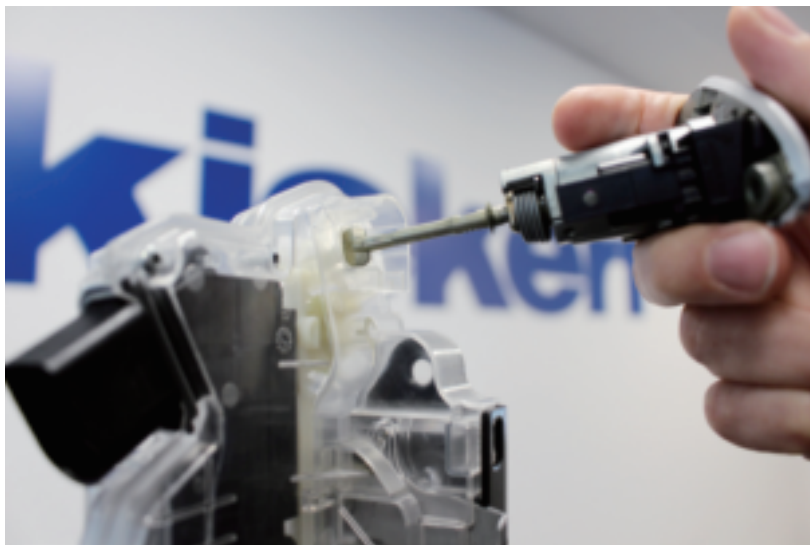
图1 锁芯和门锁之间的机械连接要求它们的位置相互靠近
