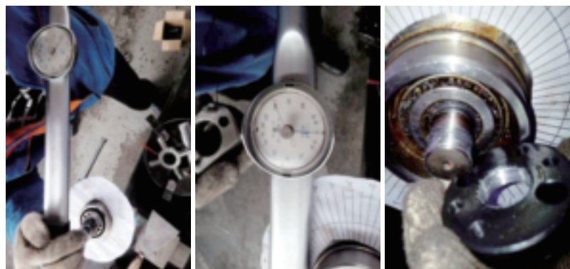
图5 改进锁紧结构松脱试验过程
