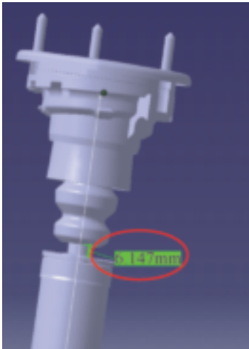
图2 减振器缸筒上端面到缓冲块下平面的距离测量
