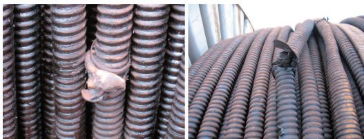
图4 PWM输出波击穿电潜泵长电缆图
