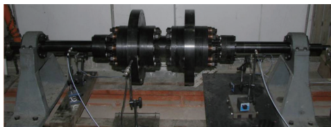
图4 燃气轮机转子试验平台
