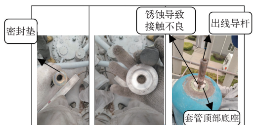
图1 套管将军帽拆解后各部件实际图
