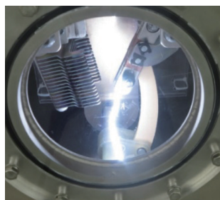
图2 动触头对金属轴（地）放电
