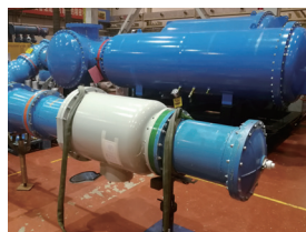
图12 工频耐压、雷电及局放试验照片图
