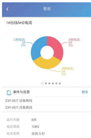
图2 配电室监控数据在移动APP端展示界面
