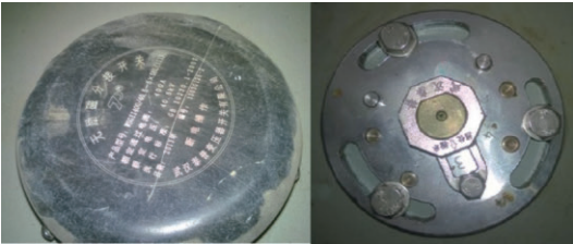
图 35 kV装置变压器分接开关
