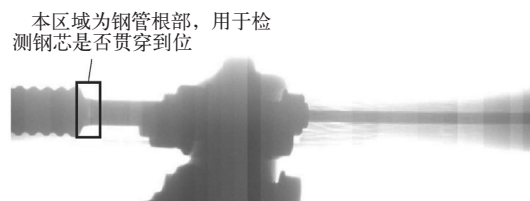
图2 钢管的X光检测示图及说明
