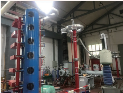
图4 雷电冲击耐压试验现场接线图
