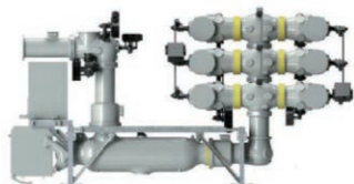
图1 典型420 kV GIS间隔布置
