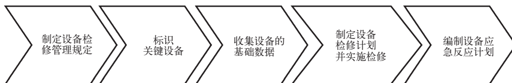
图2 预防性检修流程
