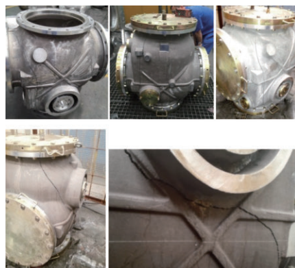
图12 五组隔离开关壳体水压试验压断裂图
