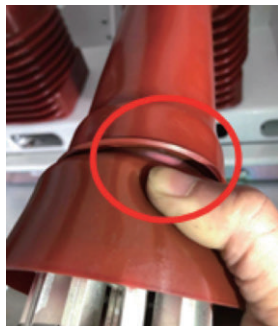
图2 绝缘层搭接处放电图
