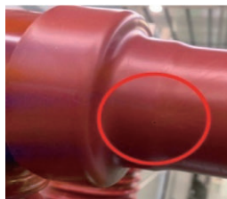
图1 B相上触臂靠近极柱处被击穿图
