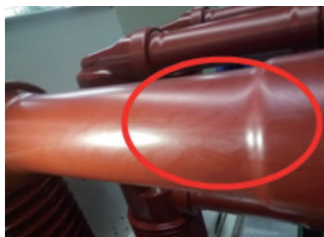
图4 触臂上的爬电痕迹图
