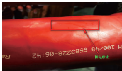
图11 双层绝缘套管的触臂耐压后
