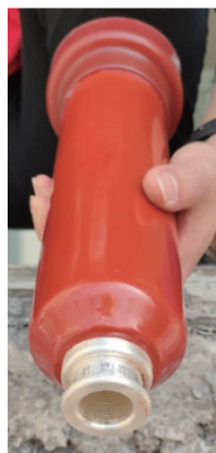
图12 触臂采用硫化涂覆工艺
