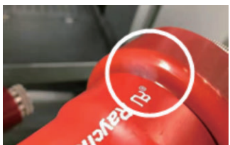
图5 绝缘层搭接处放电图
