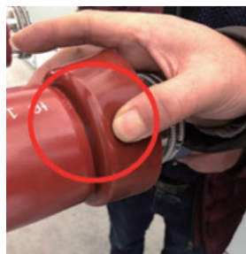
图3 绝缘层搭接处放电图
