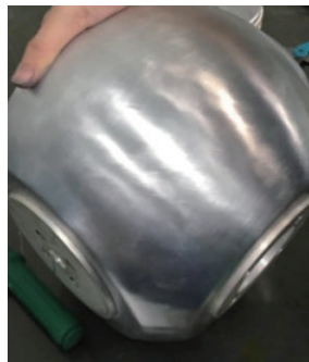
图4 改进打磨工艺后的导体
