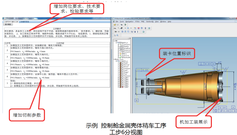
图 8 机加“一本通”岗位作业书示例图
