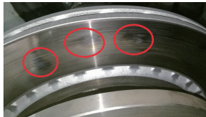
图4 DTV高温增生转化形成热斑
