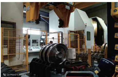
图 12 SIRMU 车削中心及自动上下料机械手结构
