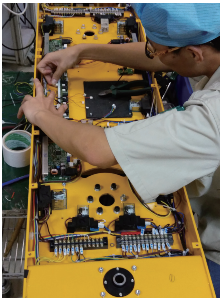
图 6 AGV 智能小车调试运行 (一)
