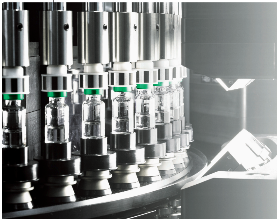
图1 药品的自动化视觉检查
