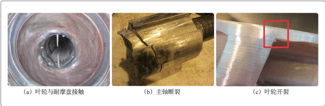
图 3 泵的故障类型
