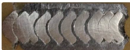
图 2 缠革垫片剖面图展现出:类似缠绕垫的缠绕结构,类似齿形垫的贴面
