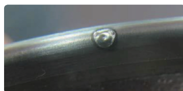
图 5 缠革垫片外圈上的激光焊点
