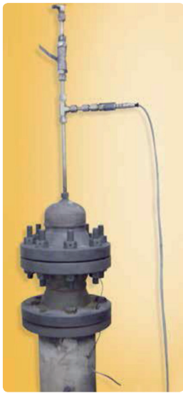
图 7 热循环测试工装照片
