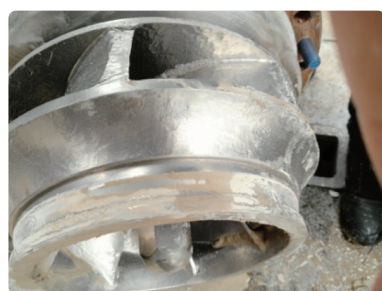
图 4 叶轮口环处磨损示意图
