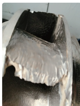
图 3 叶轮出口工作面磨损示意图
