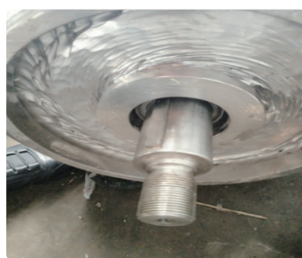
图 5 泵盖磨损示意图
