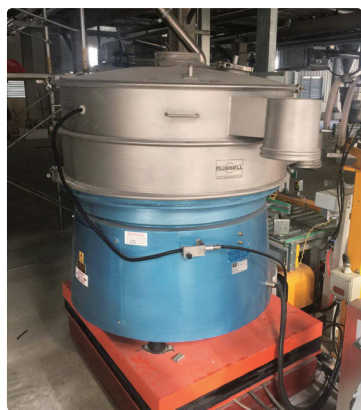
图2 安装在阿克苏诺贝尔工厂的生产线中的 Finex Separator™ 强力振动筛
