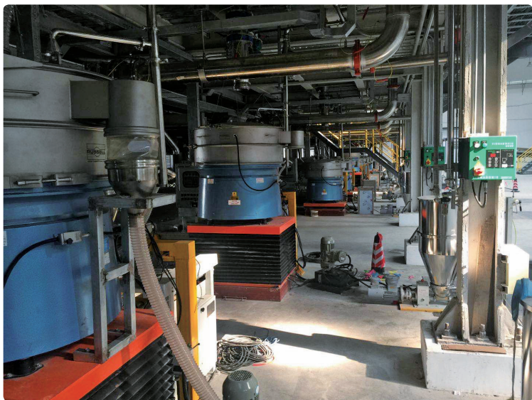
图1 在阿克苏诺贝尔工厂的生产线中将 Vibrasonic® Deblinding System 超声波防堵塞系统配合 Finex Separator™ 强力振动筛相结合
