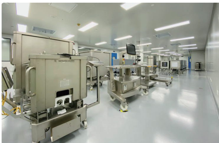
图 6 白帆生物生产车间目前有 2 条 2 000 L 一次性生产线，未来可达 6×2 000 L
