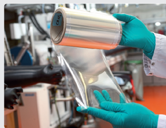
从作用上看：AEM 阴离子交换膜的聚合物化学性质是水电解性能和效率的关键
