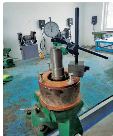
图3 自制轴承游隙检测工装
