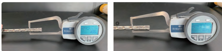
图5 波纹管的壁厚没有变化
