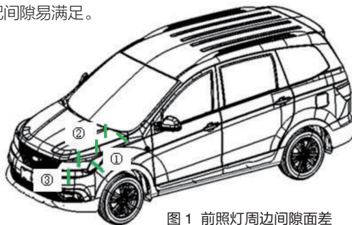
图 1 前照灯周边间隙面差
