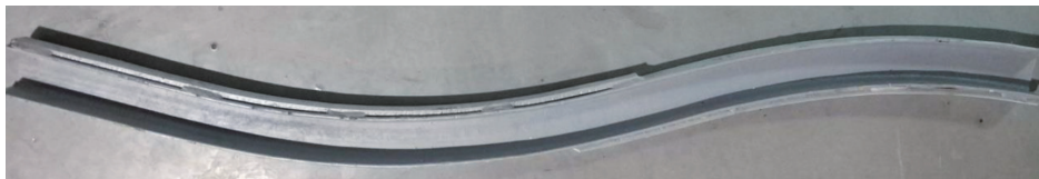
图9 加焊钢板示例
