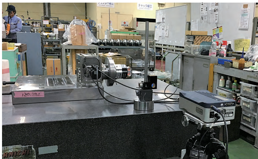
图2 使用雷尼绍 XR20-W 搭配 XL-80 激光干涉仪进行出厂前检测
